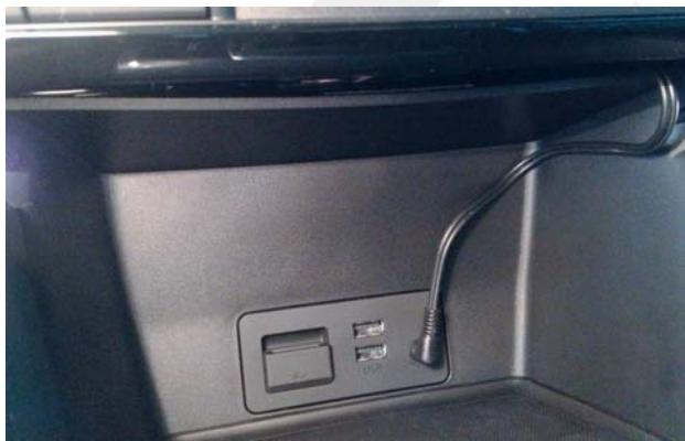
10. Кабель USB. Выведите разъём USB в место, где им будет удобно воспользоваться для подключения внешних устройств. Например, выведите разъём USB в перчаточный ящик.
