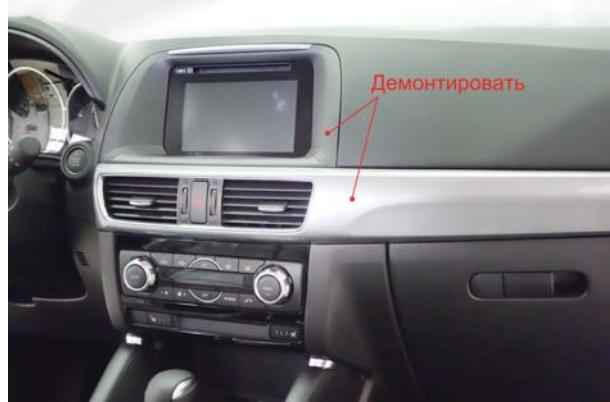
2. Выкрутите элементы крепления оригинального монитора, два самореза по бокам и один болт  $\phi 6$  мм внизу монитора. Извлеките монитор из автомобиля, отключив от него все оригинальные разъемы.
