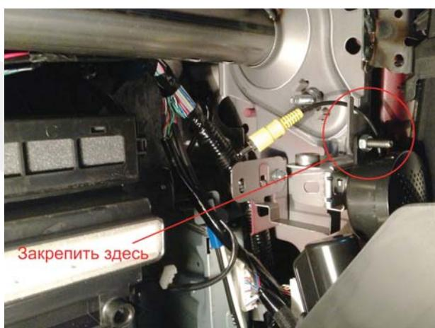
8. Установка кнопки «RESET». Установите кнопку «RESET» так, чтобы она была доступна и удобна для пользователя (водителя), а так же не мешала работе оригинальных элементов и агрегатам автомобиля. Например, кнопку можно расположить на пластиковой панели под рулевой колонкой автомобиля.
