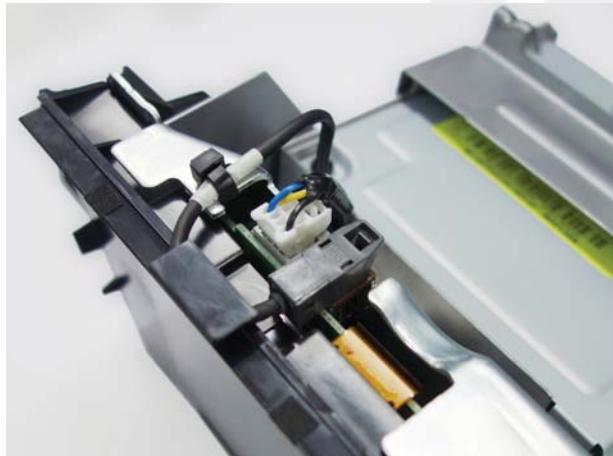
Подключите все оригинальные разъёмы к монитору. Кабели видеосигнала навигационного блока распределите соответственно, разъём входа соедините с оригинальным разъёмом, разъём выхода подключите в монитор.
