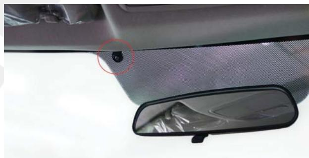
5. Установка GSM-антенны. Установите антенну в месте, где она не будет закрыта металлом и на ней не будет воздействия от высокочастотных приборов. Например, можно приклеить антенну к лобовому стеклу, уложите провода так, чтобы они не помешали работе оригинальной системы SRS AirBag.
