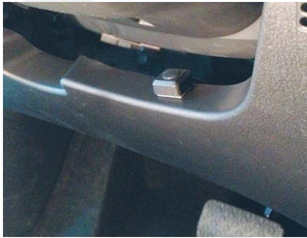
9. Кабель AUX. Выведите разъём для подключения к оригинальной розетке AUX. Сделайте это так, чтобы кабель не был натянут, и его можно было бы без труда подключать и отключать к розетке AUX. Например, как показано на этом фото.
